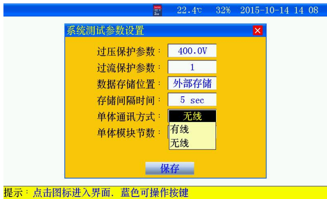
图 3.14 主机与单体模块通讯方式设置界面
