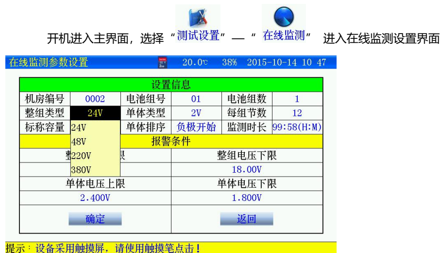
图 3.1.2 在线监测参数设置界面
