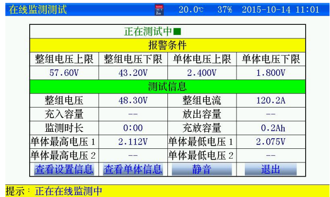
图 3.1.3 正在监测数据界面
