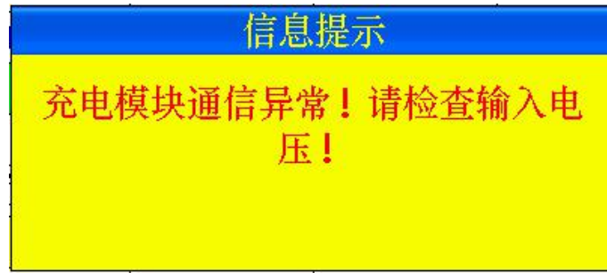
图 3.3.2-1 确定后提示，充电模块异常界面
