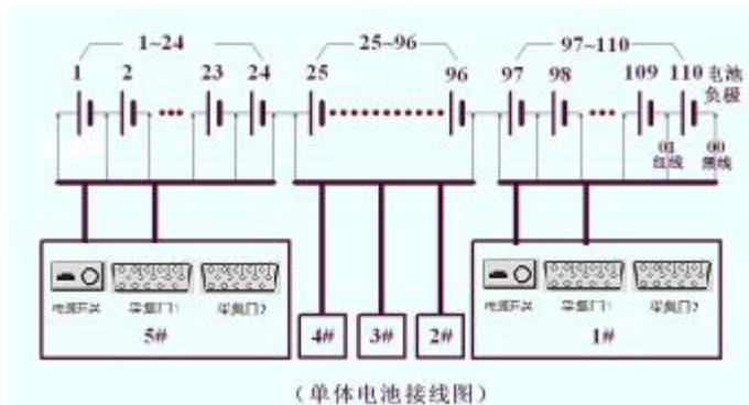
图 2.4.4-3 多个单体模块与电池连接图
