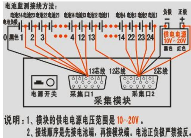
图 2.4.4 24 节 2V 电池与 1 个单体模块连接图
