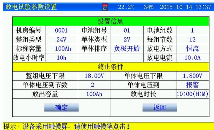
图 3.2.2 放电参数设置界面
