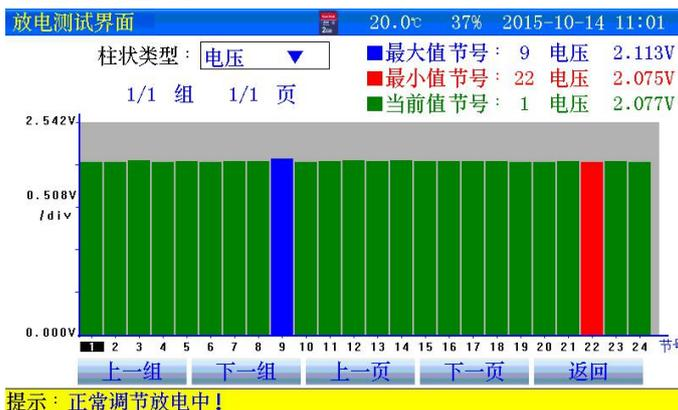
图 3.2.4-1 单体电压柱状图
